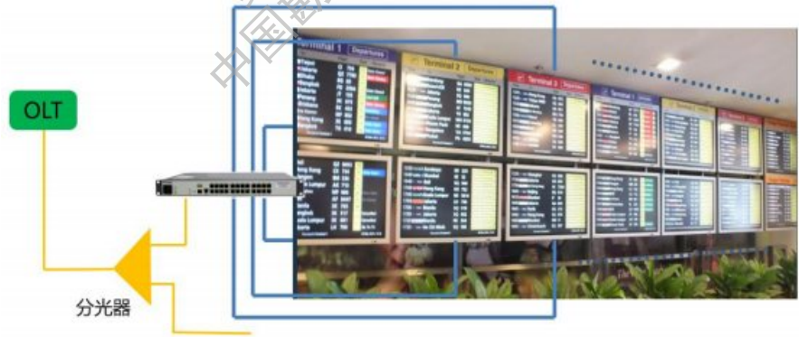
图表 3-39 航班信息显示系统 FIDS 应用组网
